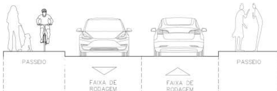
Figura 28 – Perfil transversal de área ciclável partilhada com peão
