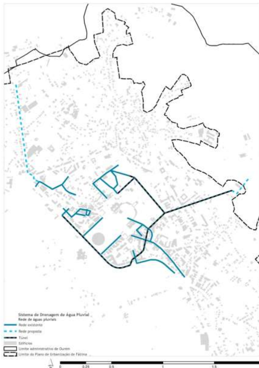
Figura 41 – Sistema de drenagem de água pluvial na área de intervenção do PUF
